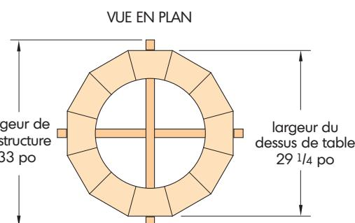
Assurez-vous que les pièces transversales de la structure (pièces « C ») mesurent de 1/8 po à 1/4 po de plus que la largeur du dessus de table (plat à plat). Cela vous permettra d'insérer le dessus de table dans la structure et de le retirer facilement.
